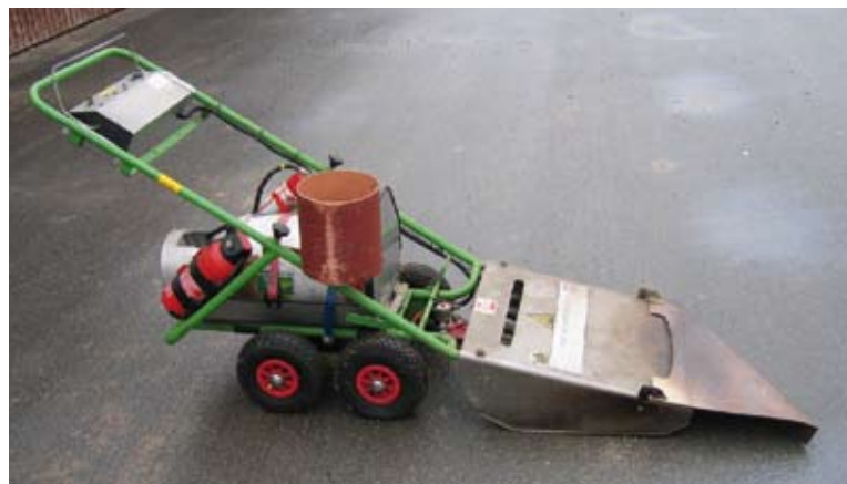
Større kærrebrænder. Benytter flydende gas
