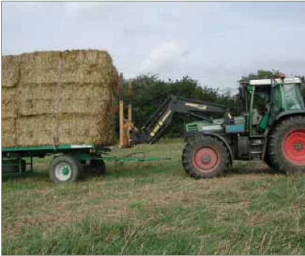
Figur 2. Når vognen er konstrueret med en holder til halmspyddet, er det en mulighed helt at afmontere halmspyddet under transport.
