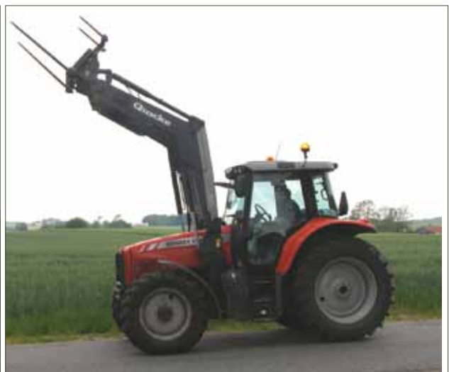
Figur 4. Ved kørsel på vej med halmspyd skal læsseren være hævet til øverste stilling.
