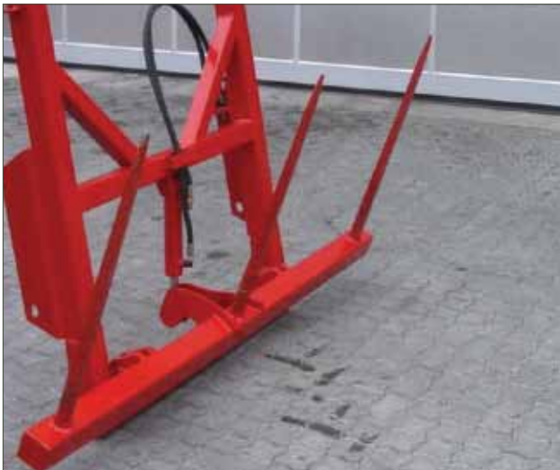
Figur 3. Nogle frontlæssere kan fås med spyd, der kan vippes op i lodret stilling. Læsseren bør da være hævet til højst 30 cm over vejbanen eller løftes helt op.
