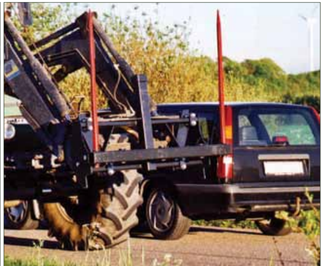
Figur 3. Nogle frontlæssere kan fås med spyd, der kan vippes op i lodret stilling. Læsseren bør da være hævet til højst 30 cm over vejbanen eller løftes helt op.
