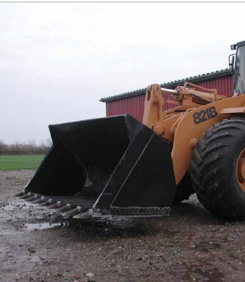
Figur 8. Hvis skovlen drejes opad, kan en bil kile sig fast under den og føreren komme meget tæt på tænderne.
