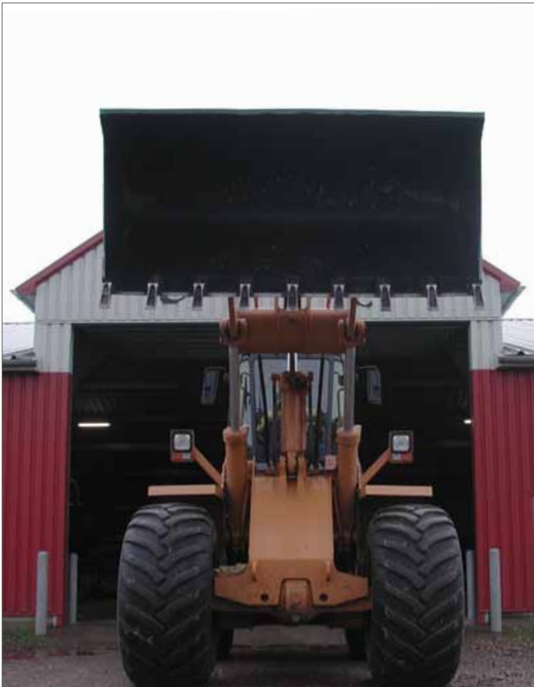
Figur 10. En gummiged må aldrig transporteres med hævet skovl, da det både forringer stabiliteten og udsynet.
