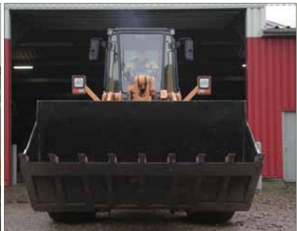
Figur 8. Hvis skovlen drejes opad, kan en bil kile sig fast under den og føreren komme meget tæt på tænderne.
