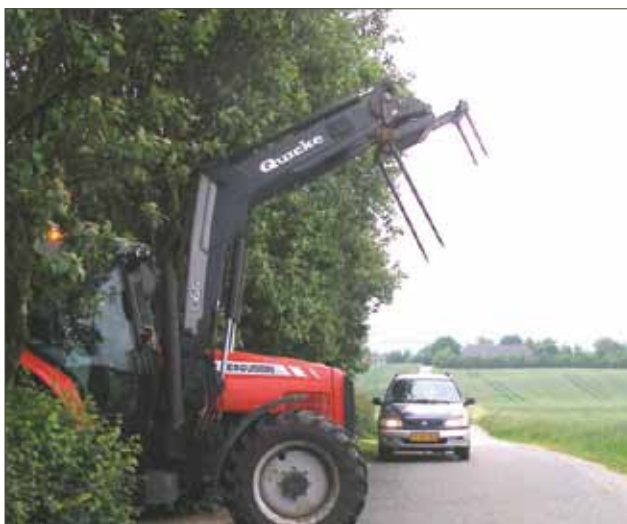
Figur 12. Ved udkørsel på vej, skal læssekæde løftes til øverste stilling.
