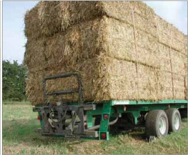
Figur 2. Når vognen er konstrueret med en holder til halmspyddet, er det en mulighed helt at afmontere halmspyddet under transport.
