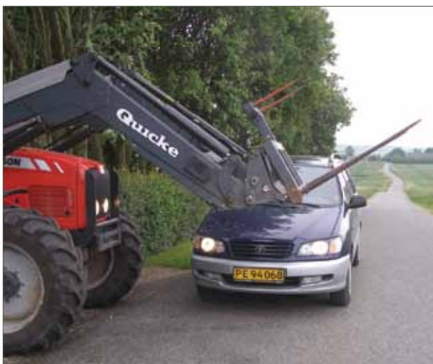
Figur 13. Køb aldrig ud med læssekæden i vindueshøjde. Det er traktorførerens ansvar, at udkørsel kan ske uden fare eller ulempe for øvrige trafikanter.
