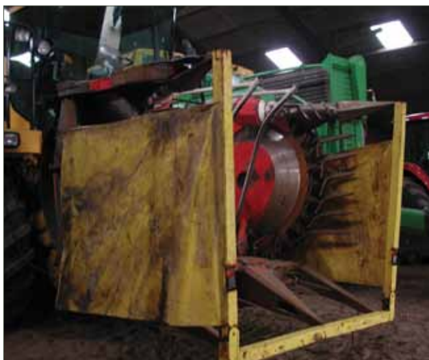
Figur 16. Eksempel på afskærmning med lygtebom som monteres ved vejtransport.
