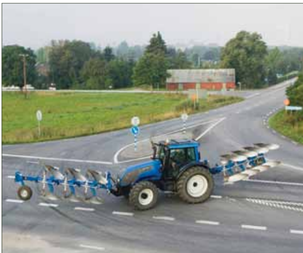
Figur 14. Lange frontredskaber udgør en særlig fare - især ved udkørsel fra sidevej eller mark.
