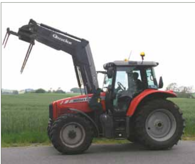
Figur 4. Ved kørsel på vej med halmspyd skal læsseren være hævet til øverste stilling.
